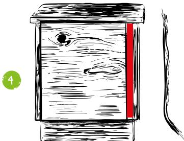
Nach dem Zusammenbau dürfen zwischen Dach und umliegenden Bauteilen keine Spalten bleiben, denn Fledermäuse mögen keinen Durchzug. Für Abhilfe sorgt beispielsweise Sisalband, das zur Abdichtung vorhandener Spalten verwendet werden kann.
