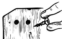
Löcher für die Schrauben vorbohren, danach, die Einzelteile zusammenschrauben.
