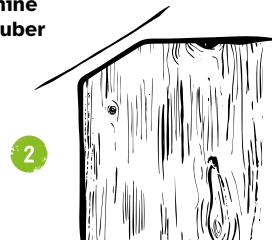
Jeweils die oberen Ränder von Rückwand, Blende und die Einflugleiste leicht anschrägen, damit das Dach nach vorne abfallend positioniert werden kann.
