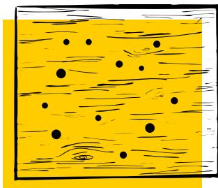
Bohren der Löcher: die Löcher werden mit einem Holzbohrer etwa 10 cm tief in das Längsholz gebohrt. Es sollten verschiedene Bohrgrößen zwischen 2 und 8 mm verwendet werden. Die Kanten der Löcher werden anschließend mit Schleifpapier sauber abgeschliffen.
